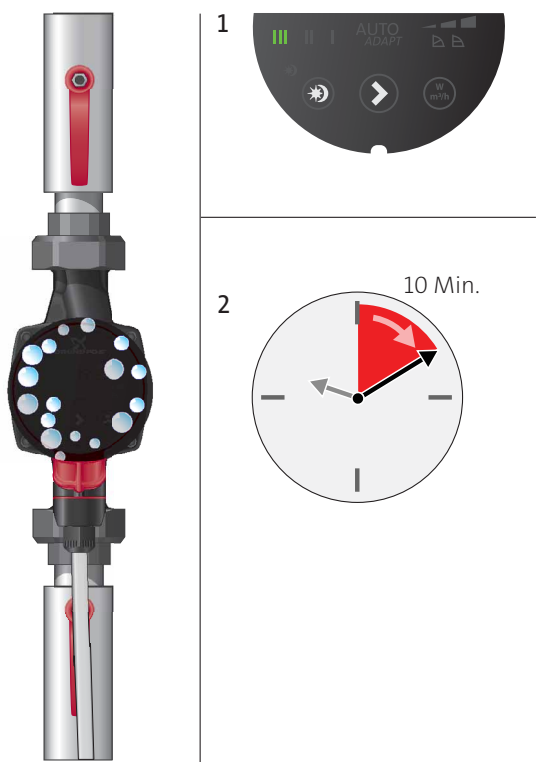
Afb. 24 Ontluchten van de pomp
